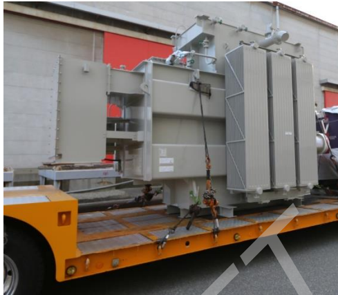
図1—全装可搬形変圧器の輸送荷姿の例（7 MVA，66/6.6 kV 三相変圧器）
