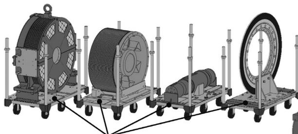
搬入専用台車(短辺:700mm、最大質量:1,154kg)
