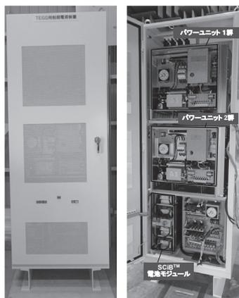
図1 開発した制御電源自給装置
