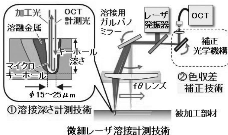
微細レーザー溶接計測技術
