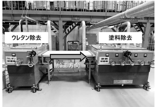
図4 ガラス研磨システムの外観
